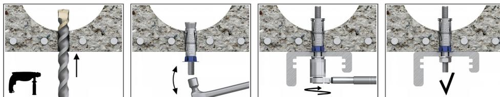
1. Высверлить отверстие заданных диаметра и глубины
